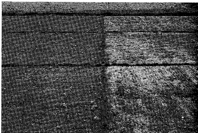
Einfluß der Tragschicht auf die Auflafrate der Rasenansaat links: 30 Vol.-% Lavasand, 30 Vol.-% Flußsand, 10 Vol.-% Lößboden, 30 Vol.-% Weißtorf rechts: 60 Vol.-% Flußsand, 10 Vol.-% Lößboden, 30 Vol.-% Weißtorf
