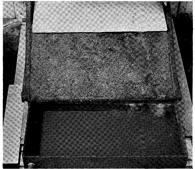
Abb. 3a: Einfluß von Erosionsschutz-Mitteln auf die Wassererosion an Hängen (45°) – Mit Mittelanwendung nach 21 Minuten
